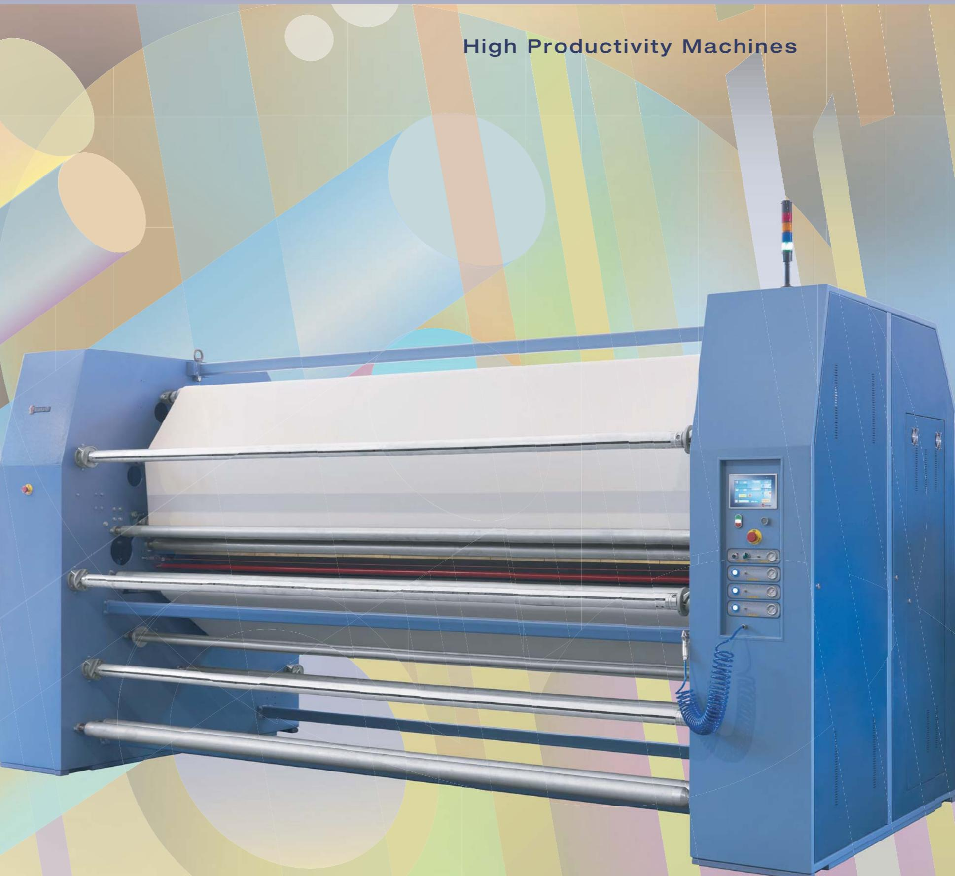
**I** Macchine rotative ad alta produttività (4,3 mt/min - 4,7yd/min) per stampa transfer in sublimatico da carta transfer a tessuti sintetici, lavorati a maglia o stoffa non tessuta come poliestere, nylon, acrilico. Nel caso di stampe fatte direttamente su tessuto di poliestere con l'ausilio di stampanti digitali, si può usare la calandra per fissare i pigmenti di colore in modo perfetto ed economico.
